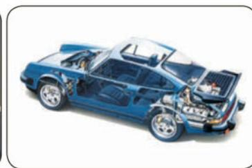
**1985 - CARRERA 3.2.** L'apparition des versions catalysées réduit la puissance à 217 ch en Europe.
