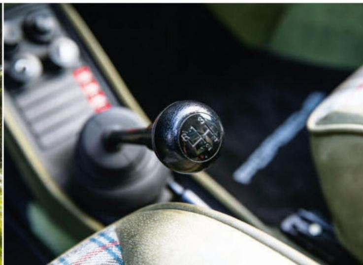
Il était bien rare de croiser une 911 Turbo sur les routes, encore plus de l'apercevoir autrement que sous cet angle. Quant au pilote, il devait composer avec une boîte à seulement quatre rapports. Une transmission, solide, nécessitée par le couple impressionnant de la 930.
