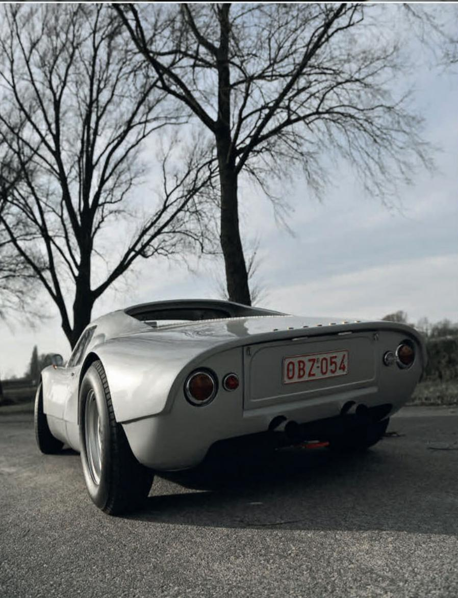
La 904 est constituée de deux moitiés, le soubassement et la carrosserie proprement dite, simplement collées et rivetées entre elles et sur un châssis métallique minimal.
