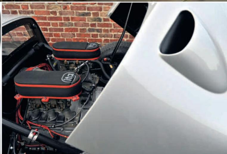
Sous le vaste capot qui s'articule vers l'arrière, le quatre cylindres en version 155 ou 180 ch. Mais il y eut aussi le flat-six de 911 et même un flat-eight, qui, pour être à plat n'en était pas moins gonflé.
