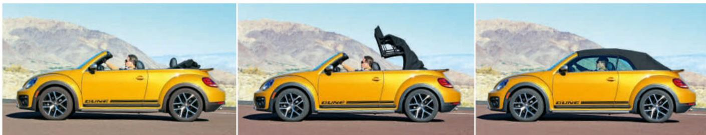
La capote est entièrement automatique, s'ouvre en moins de dix secondes et se referme en à peine davantage. Elle peut se manoeuvrer jusqu'à 50 km/h.
