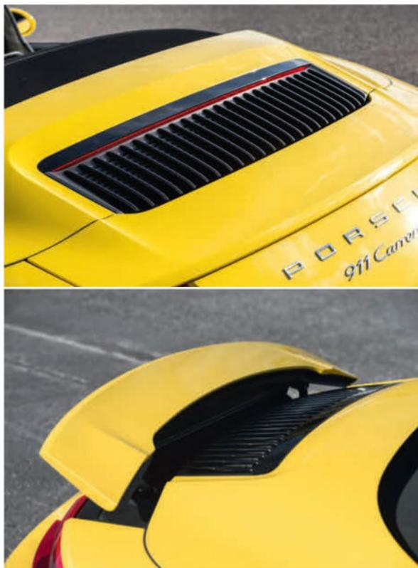
Le passage à la suralimentation par deux turbocompresseurs s'accompagne d'une nouvelle grille de moteur à lamelles verticales. L'aile est toujours rétractable.
